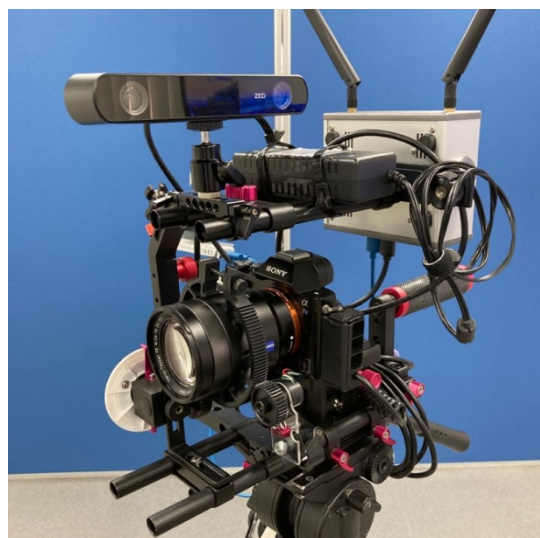
IMU+2 眼 3D カメラセンサーと LinkBox の組み合わせ (試作品)
